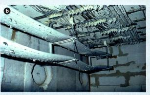
**Figure 2** Un test fonctionnel est effectué afin de s'assurer que même en cas d'incendie, les systèmes de câbles importants pour la sécurité ne provoquent pas de court-circuit et ne soient pas interrompus. (a) Montage avant l'essai. (b) Montage après l'essai.
