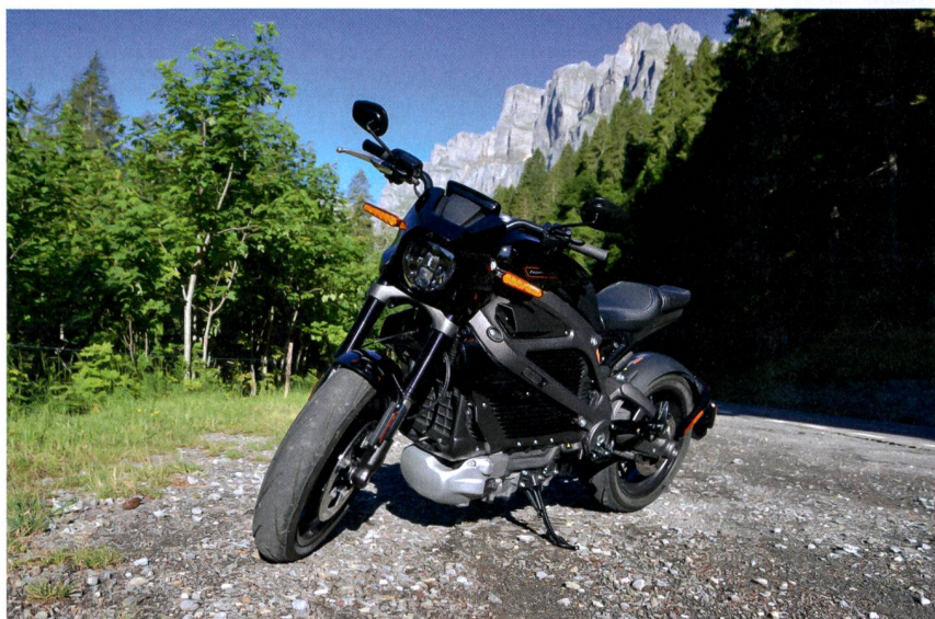
Auf dem Klausenpass. Der flüssigkeitsgekühlte Motor liegt zuunterst und sorgt für einen niedrigen Schwerpunkt, der sich positiv auf das Kurvenverhalten auswirkt.
