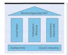
**Bild 3** Darstellung des Fundaments und der drei Pfeiler des Monitoringkonzepts des Niederspannungsnetzes.
