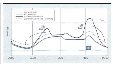
**Bild 1** Beispielhaftes Lastprofil in einem Quartier. Die Elektromobilität verursacht durch die hohe Gleichzeitigkeit und relativ hohen Ladeleistungen Lastspitzen, die gebrochen werden sollen.
