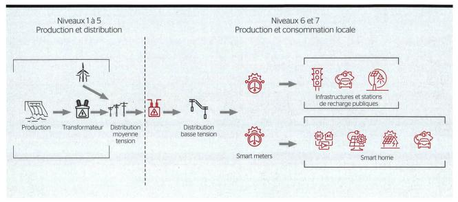
Figure 1 Les 7 niveaux du réseau électrique : en rouge, les éléments couverts dans cet article.
