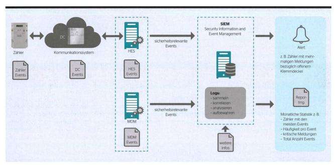
Bild 2 Grundlegende Funktionsweise eines Siem für Smart Metering.
