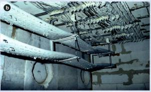
**Bild 2** Um sicherzustellen, dass sicherheitsrelevante Kabelanlagen auch im Brandfall weder einen Kurzschluss verursachen noch unterbrochen werden, wird eine Funktionsprüfung durchgeführt. (a) Versuchsaufbau vor der Prüfung, (b) Versuchsaufbau nach der Prüfung.
