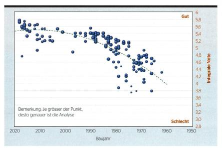
Bild 4 Integrale Note in Funktion des Baujahres.
