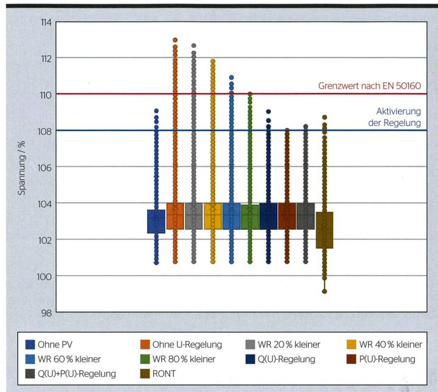
Bild 1 Boxplots aller simulierten Spannungswerte eines Jahres.
