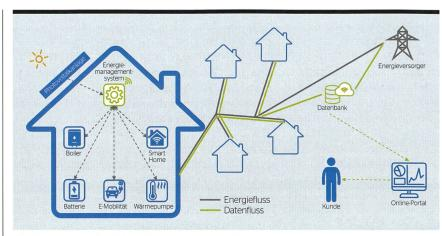
Funktionsweise eines Energiemanagementsystems.
