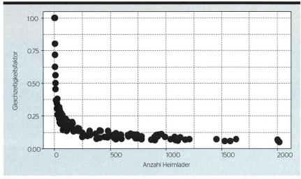
**Bild 2** Entwicklung des Gleichzeitigkeitsfaktors in Abhängigkeit der Anzahl installierter privater Heimladestationen.
