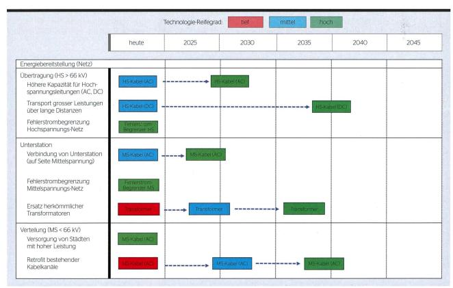
Die «Application Readiness Map» für Hochtemperatur-Supraleiter im Stromnetz: Ein hoher Technologie-Reifegrad (grün) bedeutet, dass eine Anwendung als Prototyp vorhanden oder bereits in Betrieb ist. Bei einem mittleren Reifegrad (blau) wurde die Technologie im Labor oder auf dem Feld demonstriert. Bei einem tiefen Reifegrad (rot) liegt bestenfalls ein Proof of Concept vor.
