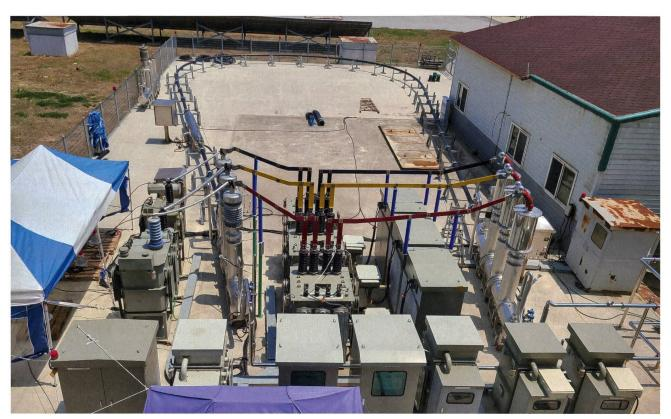
Typentest eines HTS-Kabels (23 kV 60 MVA) in Gochang.
