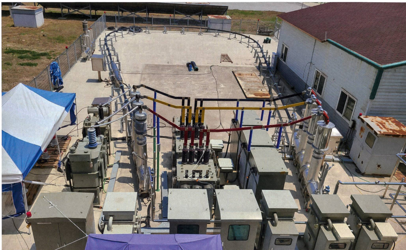
Typentest eines HTS-Kabels (23 kV 60 MVA) in Gochang.
