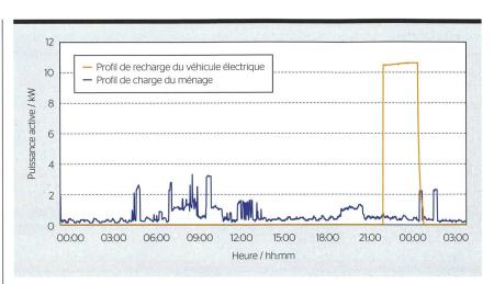
**Figure 1** Profil de charge courant avec et sans véhicule électrique pour une maison individuelle (exemple de référence avec une puissance de recharge de 11 kW).
