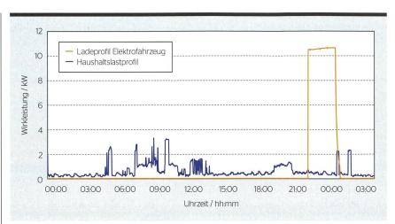
**Bild 1** Gängiges Lastprofil mit und ohne Elektrofahrzeug bei einem Einfamilienhaus (Referenzbeispiel mit Ladeleistung 11 kW).
