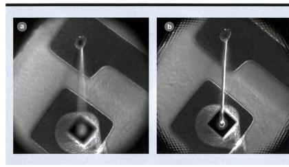
Die Tiefenschärfe der Standardkamera (a) ist etwa sechsmal geringer als die der Lichtfeldkamera (b).
