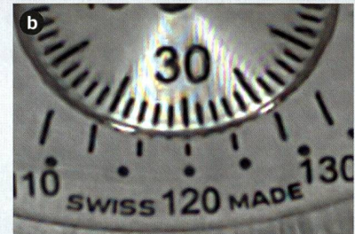
a) 2D-Rohbild mit den runden Mikrolinsen, b) Rekonstruiertes Bild mit Tiefeninformation.
