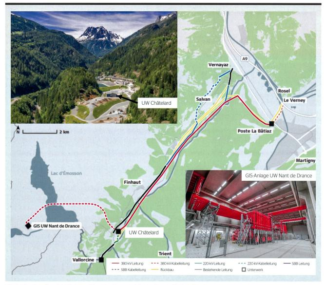
Bild 1 Situationsübersicht Netzanschluss des Pumpspeicherkraftwerks Nant de Drance.
