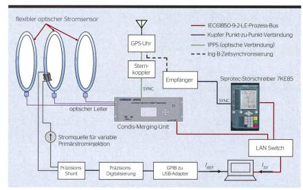
Bild 4 DC-Test mit Factory-Acceptance-Test-Setup.
