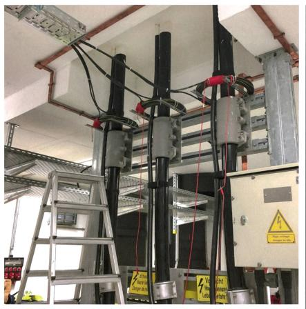
**Bild 7** Site-Acceptance-Test-Setup mit mehreren Kupferwickeln für die Primärspeisung des flexiblen optischen Stromwandlers.
