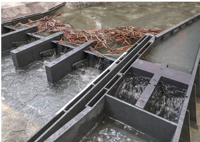
Modèle physique (PL-LCH EPFL) : essais de transit du bois flottant en cas de crues.
