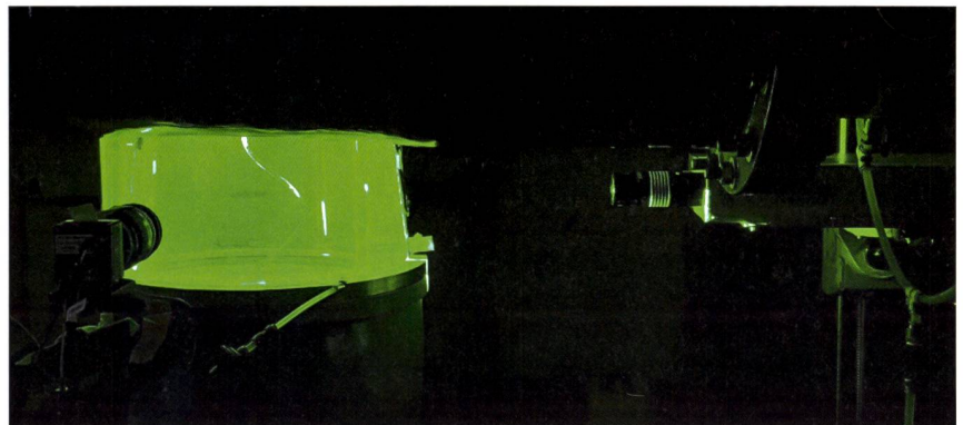
Bild 2 Messung der Blasenbildung (Kavitation), die in Francis-Turbinen bei bestimmten Betriebsarten durch Wirbel entsteht, mit der Methode der «Particle Image Velocimetry».
