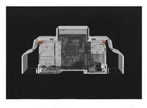
Querschnitt durch den MID-Energiezähler.
