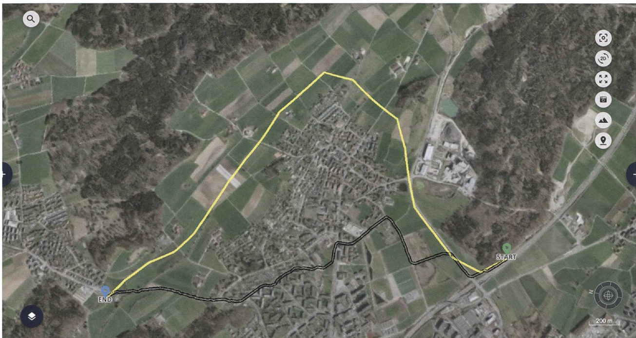
Vergleich zweier 110-kV-Leitungen (gelb = Freileitung; schwarz = Erdkabel).
