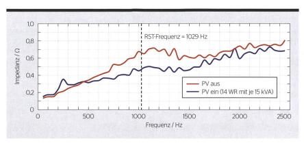
Bild 5 Veränderung der fNI durch den Betrieb einer 210-kVA-PV-Anlage.
