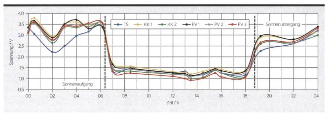
Bild 4 Gemessener Verlauf der RST-Spannungspegel über einen Tag (TS = Trafostation, KK = Kabelkabine, PV = PV-Anlage).
