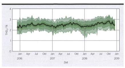
**Bild 1** THDu, Streuung der 95-%-Werte von 69 Messpunkten, schwarze Kurve: Median, die unterschiedlichen Grüntöne markieren das O-/5-/25-/75-/95-/100-%-Quantil.
