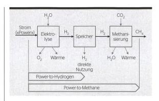
**Bild 1** Blockflussdiagramm für den Power-to-Gas-Prozess [6]
