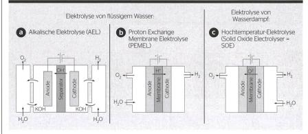
Bild 2 Bauformen von Elektrolyseuren.[9]
