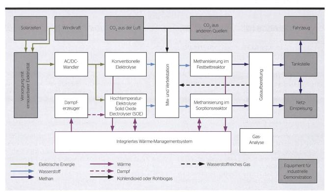
Bild 4 Blockflussdiagramm des High Efficiency Power-to-Methane Piloten, HEPP.
