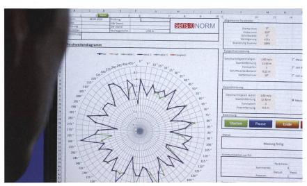
Messdaten einer Sensor-Prüfung nach SensNorm. Davon werden die Planungsdaten abgeleitet, die dem Elektroplaner als Grundlage für die Sensorplanung dienen.
