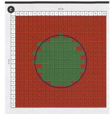
**Figure 4** Exemples de résultats représentant: (a) une zone de détection radiale (en vert), (b) une zone de détection tangentielle (en orange) et (c) une mesure de présence. La forme géométrique idéalisée correspondante (cercles bleus) est représentée dans chaque diagramme, en tenant compte du critère des 15 % (au maximum 15 % de points de mesure non détectés dans chaque cercle).
