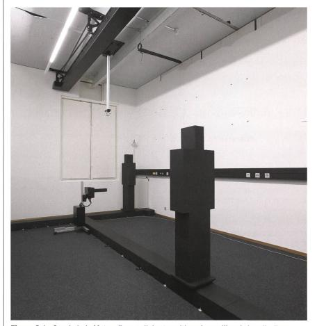
**Figure 3** Le SensLab de Metas: l'axe radial est positionné au milieu de la salle, l'axe tangentiel à son extrémité. Entre les deux se trouve le bras de test, tandis que le capteur monté sur l'entraînement fixé au plafond est situé à une hauteur typique de 2,5 m.
