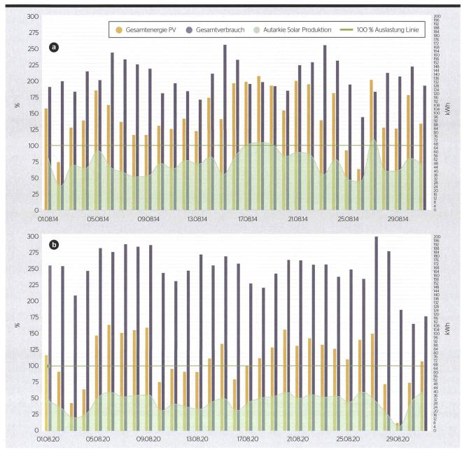
**Bild 1** Der Vergleich der Daten aus dem Navigator von August 2014 und August 2020 zeigt den Leistungsabfall der Bleibatterie deutlich. Während 2014 bis zu 120 kWh Solarstrom täglich genutzt werden konnten, waren es 2020 nur noch 100 kWh. Die Produktion der Solaranlage war tatsächlich höher, konnte aber nicht genutzt werden, weil sie nicht mehr in der Batterie gespeichert werden konnte. Zudem erhöhte sich der Verbrauch wegen der ineffizienten Ladung der Bleibatterie durch das BHKW.
