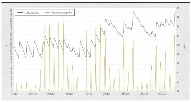
Bild 3 Selbst als die Monte-Rosa-Hütte im Januar im Schatten stand, reichte die Solarenergie an sonnigen Tagen aus, um den Tagesbedarf der Hütte im Winterbetrieb zu decken. Unterschritt der Ladezustand 20 %, schaltete sich das BHKW ein. Ende Januar 2021 konnte die Batterie vier sonnenarme Tage überbrücken.
