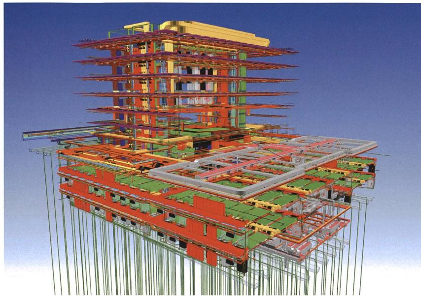
**Bild 2** BIM-Darstellung der Gebäudetechnik des HPQ. **Kanäle:** Die Zuluft ist rot, die Abluft gelb und die Außenluft grün dargestellt. **Leitungen:** Heizung ist rot, Kälte ist dunkelblau, technische Kälte ist blau/cyan, Laborkühlwasser ist hellgrün. **Elektroinstallationen** sind orange, rot und braun.
