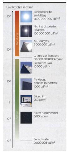
**Bild 1** Leuchtdichten verschiedener Oberflächen.[3]
