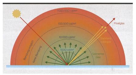
**Bild 2** Reflexions- und Blendverhalten verschiedener Gläser (Leuchtdichte in cd/m² und Bündelaufweitung). Die Grenze zwischen «Blendung möglich» und «keine Blendung» ist fliessend.[3]
