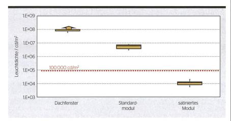
**Bild 5** Leuchtdichte von Dachfenster, Standardmodul und satiniertem Modul beim Pilotprojekt. Die Streuungen basieren auf der Variation von Beobachtungspunkt, Messpunkt und Uhrzeit der Messung. Die Messungen für Dachfenster und Standardmodul wurden während einem Blendereignis vorgenommen.
