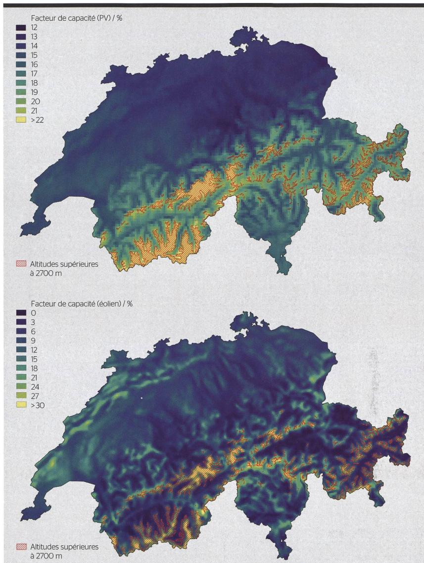
**Figure 1** Distribution spatiale des facteurs de capacité pour le photovoltaïque (en haut) et l'éolien (en bas). La résolution spatiale est basée sur les modèles utilisés respective-ment pour les calculs: 1,6 km x 2,3 km pour l'énergie solaire et 1,1 km x 1,1 km pour l'éner-gie éolienne. Les altitudes supérieures à 2700 m ont été exclues.
