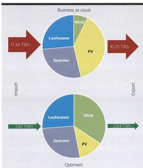
**Bild 3** Vergleich von Import und Export für zwei Produktionsportfolios. **Oben:** Business as usual, 15 % Windkraft und 85 % PV, installiert auf Hausdächern in urbanen Gebieten. **Unten:** Ergebnis der Optimierung, 75 % Windkraft und 25 % PV an Standorten, die mit Hilfe der Evolutionsstrategie ausgewählt wurden.
