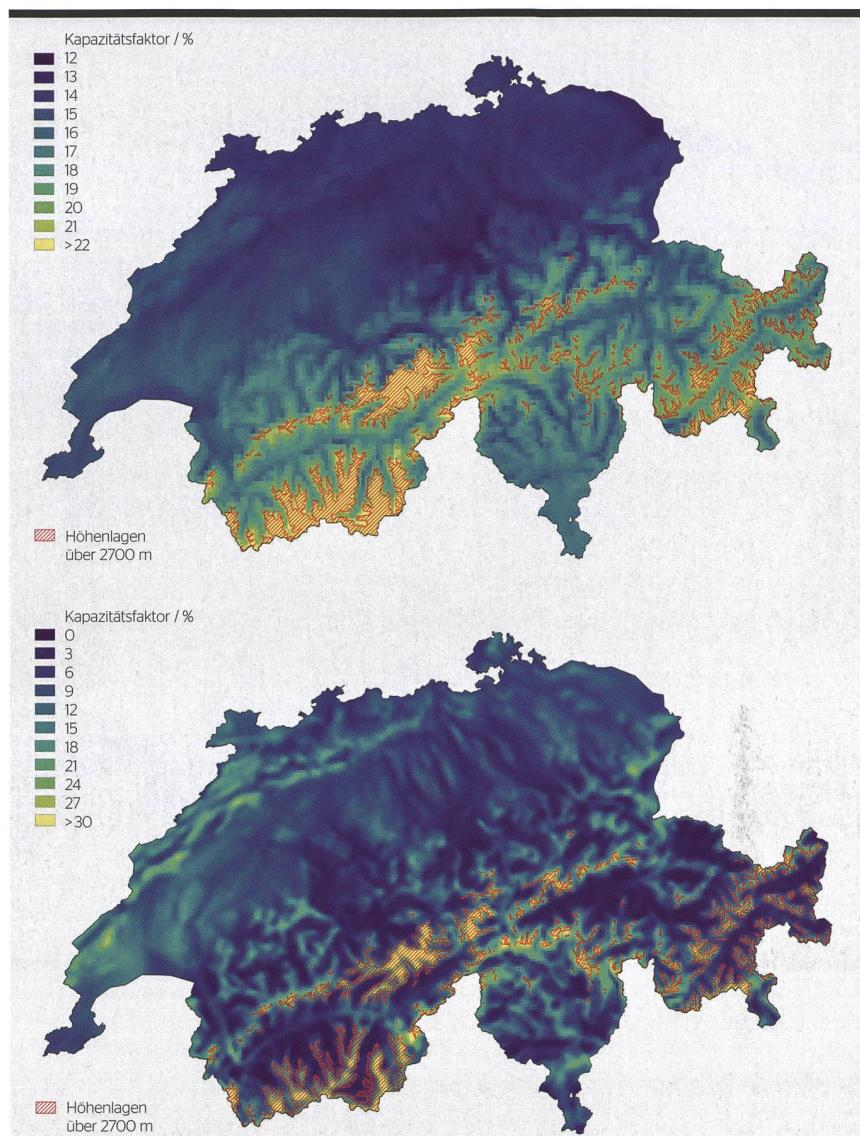
**Bild 1** Räumliche Verteilung der Kapazitätsfaktoren für PV (oben) und Windkraft (unten).
