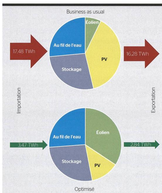
**Figure 3** Comparaison des importations et des exportations pour deux portefeuilles de production. **En haut:** Business as usual, soit 15 % d'éolien et 85 % de PV installé sur les toits des zones urbaines. **En bas:** résultat de l'optimisation, soit 75 % d'éolien et 25 % de PV, installés sur les sites sélectionnés à l'aide de la stratégie évolutionnaire.
