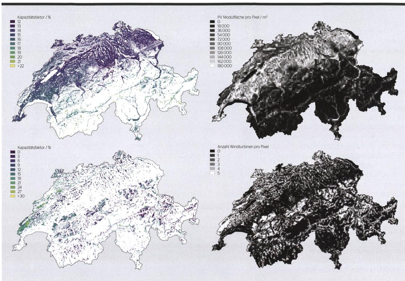
**Bild 2** Mögliche Standorte für Solar- (oben) und Windkraftanlagen (unten) nach Anwendung aller Ausschlusskriterien. Die weissen Gebiete sind ungeeignet. **Links:** Kapazitätsfaktoren der geeigneten Gebiete, 50 m räumliche Auflösung. **Rechts:** Aufsummierte Installationskapazitäten für PV-Module und Windturbinen. Auflösung basiert auf den respektiven Modellen, die zur Berechnung benutzt wurden: 1,6 km x 2,3 km für Solarenergie und 1,1 km x 1,1 km für Windkraft.
