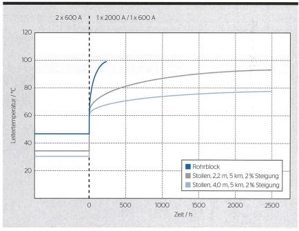
**Bild 2** Leitertemperatur in Funktion der Zeit für zweisträngige Kabelleitungen unterschiedlicher Ausführung. Die Ausgangstemperatur bezieht sich auf eine lange Vorbelastung von 600 A. Zum Zeitpunkt null erfolgt ein Sprung auf 2000 A Maximallast. Stationäre Temperaturen werden beim Rohrblock nach Wochen und bei gelüfteten Stollen erst nach Monaten erreicht.
