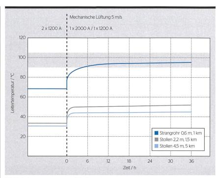
**Bild 7** Leitertemperatur von Kabelleitungen unterschiedlicher Ausführungen beim Sprung auf Maximallast, unter mechanischer Lüftung mit 5 m/s. Das Bild illustriert die höhere Effizienz der Lüftung bei grösseren Rohr- resp. Stollendurchmessern. Bei grossen Stollen fliesst die Wärme vor allem radial ab, dank der ausgedehnten Oberfläche.
