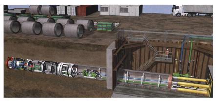
Bild 3 Illustration zum Microtunneling resp. Rohrvortrieb.
