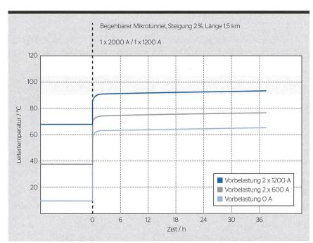
**Bild 6** Leitertemperatur beim Sprung auf Maximallast, ausgehend von verschiedenen Vorbelastungen: Keine, 600 A, 1200 A. Eine hohe Vorbelastung füllt die Wärmespeicher der umgebenden Massen, so dass die Zusatzwärme nach dem Lastsprung verstärkt axial abgeführt werden muss.
