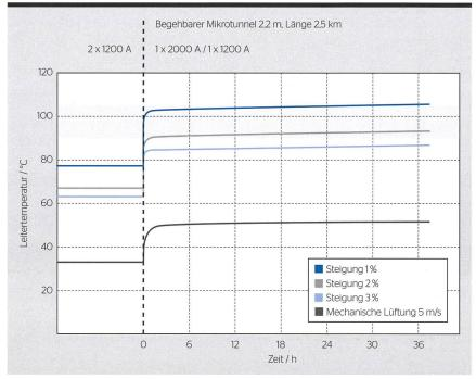
**Bild 4** Leitertemperatur einer zweisträngigen Kabelleitung im Mikrotunnel mit Lüftung unterschiedlicher Stärke. Lastsprung von 1200 A Dauerlast auf 2000 A. Das Bild zeigt den grossen Einfluss der Intensität des Luftstroms auf die Wärmeabfuhr resp. Belastbarkeit der Kabelleitung.
