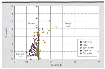
**Figure 3** Utilisation du réseau (GU) pour l'achat (import) et l'injection (export) pour les 41 bâtiments, et ce, pour chacun des différents modèles tarifaires. Cette figure permet de classifier le comportement des différents systèmes.
