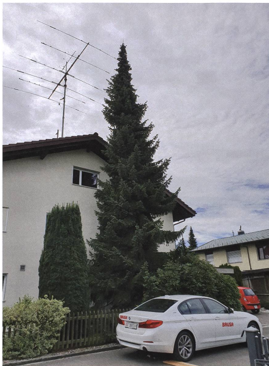
Installation de test avec le WPT-EV à une distance horizontale de 11 m de l'antenne Yagi culminant à 17 m de hauteur.
