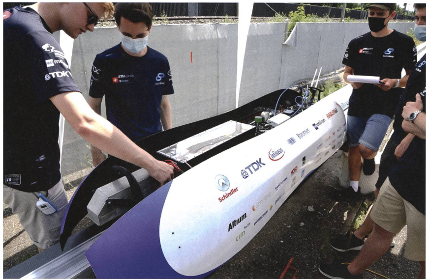
Für Arbeiten lässt sich der Pod oben öffnen. Dabei müssen wegen der Batteriespannung von 600 V strikte Sicherheitsprozeduren eingehalten werden.
