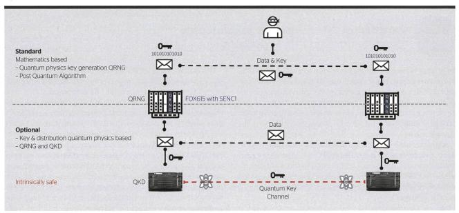
**Figure 2** Pour sécuriser les données, il est possible d'utiliser une clé quantique (QRNG) en combinaison avec un algorithme post-quantique (solution standard) ou, en option, une clé quantique dont la distribution est également basée sur la physique quantique (QKD).
