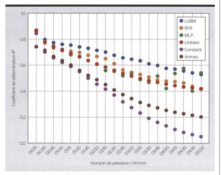
**Figure 4** Coefficient de détermination des différents modèles de prédiction testés pour des prédictions allant de 15 min à 5 h à l'avance.
