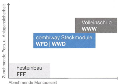
Positionierung der Combiway-Steckmodule.
