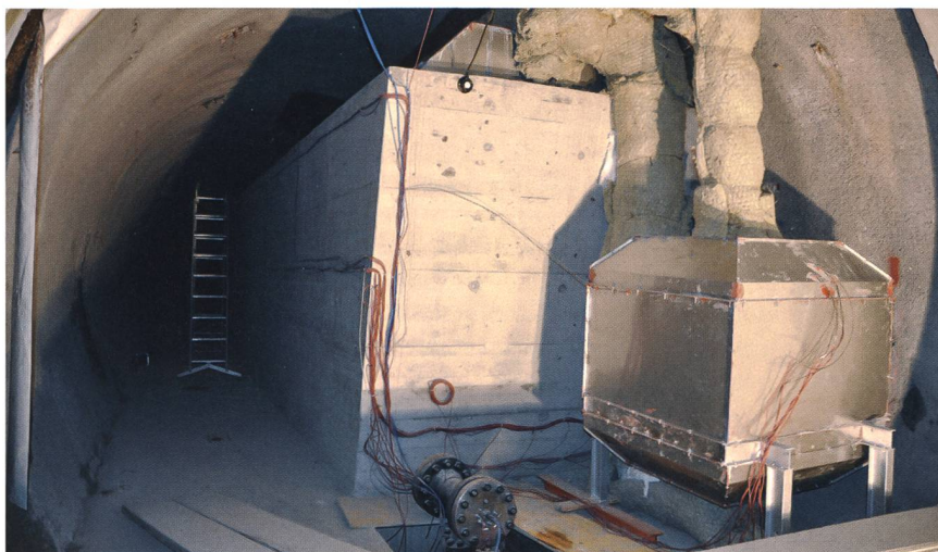
Sensibel-latenter thermischer Speicher in der Pilotanlage bei Polleggio. Links ist der mit Kieselsteinen gefüllte sensible Speicher, rechts der latente Speicher zu sehen. Der sensible Speicher ist 3,1 m hoch, 9,9 m lang und 4 m breit. Der latente Speicher ist etwa 1,5 m hoch, lang und breit.
