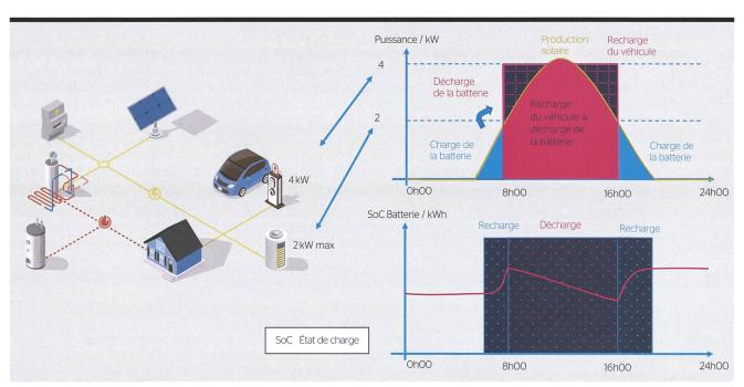
**Figure 1** Exemple simplifié de gestion automatisée optimale dans le contexte d'un bâtiment: recharge du véhicule ou de la batterie en fonction des contraintes de puissance disponible et de la production solaire.
