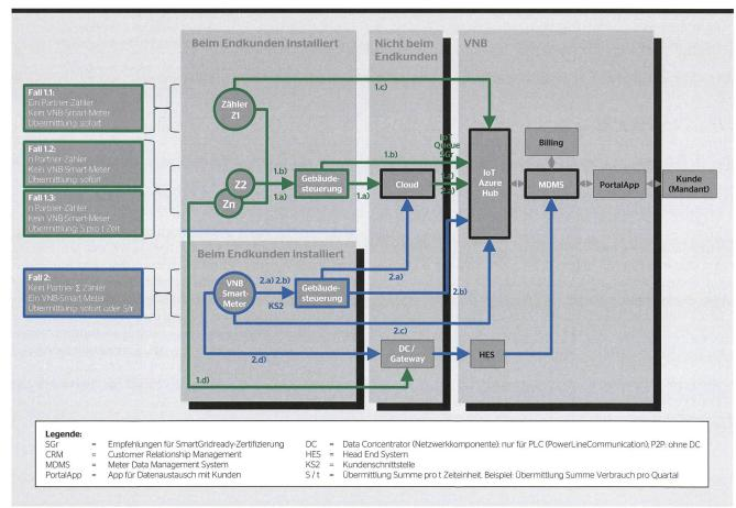
Bild 2 Übersicht über die verschiedenen Daten-Transportwege, die zwischen privaten Systemen und den Systemen des VNB möglich sind.
