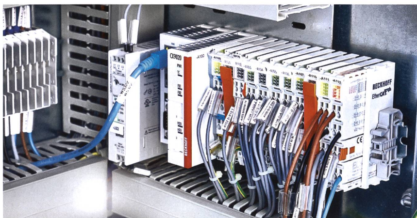
PC embarqué CX9020 avec E/S (technique de mesure intégrée).
