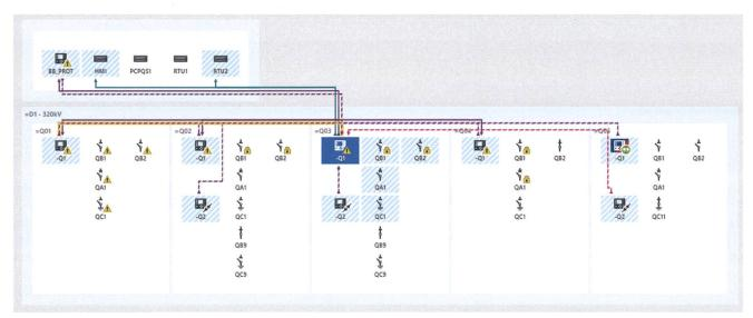
Bild 2 Beispiel SCD, in StationScout geladen.
