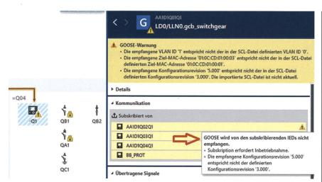
Bild 3 Prüfung von Goose-Publisher-Subscriber-Verbindungen.
