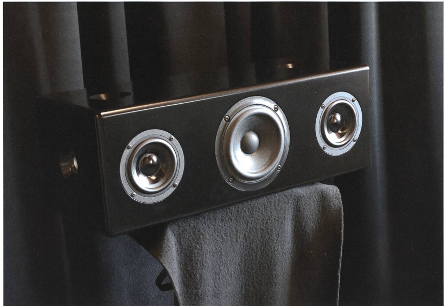
Ein Soundbar-Prototyp mit seitlichen Treibern, der für Versuche eingesetzt wird.
