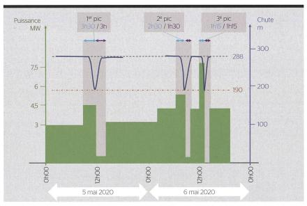
Lors de la seconde campagne d'essais, la totalité du volume de stockage identifié a été utilisée pour la production d'énergie de pointe. Trois pics de production ont été générés sur deux jours, afin de tester différentes vitesses d'abaissement du niveau et de remplissage de la galerie en charge et d'évaluer la hauteur de chute minimale permettant un fonctionnement des turbines en tout sécurité.
