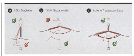
**Bild 1** Standard-Isolatoren für 110 kV sind zu lang für Masten mit nah übereinanderliegenden Auslegern (a). Zwei Isolatoren in Längsrichtung übertragen horizontale Kräfte zu direkt (b). Drei in Y-Form angeordnete Isolatoren mit einer isolierten Leiterschlaufe erfüllen sowohl die elektrischen als auch die statischen Anforderungen (c).
