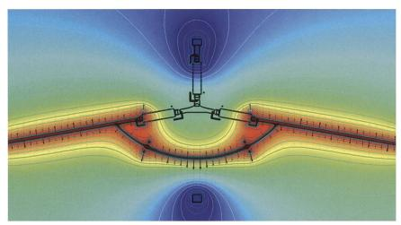
**Bild 2** Die Feldberechnungen zeigen, dass die isolierte Tragabspannkette auch bei engen Platzverhältnissen eingesetzt werden kann.
