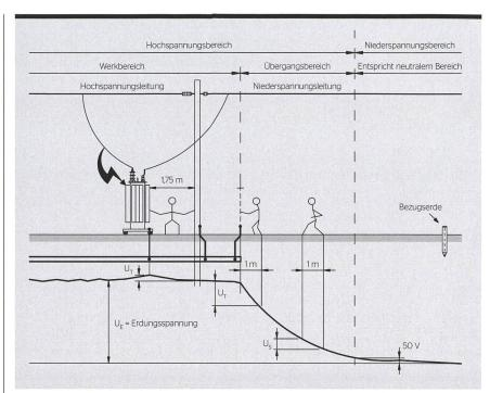
Bild 1 Anlagenbereiche und Einwirkspannungen (SNG 483755, Figur 7).
