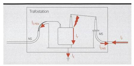
Bild 3 Trafostation mit Niederspannungs- (NS) und Mittelspannungsabgängen (MS).
