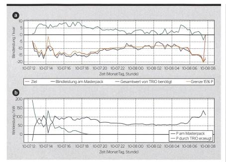
**Bild 3** a) Die grüne Kurve zeigt die von den Wechselrichtern abgerufene Blindleistung. Orange: Hauptsollwert. Die Wechselrichter sorgen dafür, dass die Blindleistung im Werk 15 % der Wirkleistung nicht überschreitet (Vorgabe). Violett: tatsächliches Verhalten des Systems. b) Netzbezug (blau) und Solarstrom (grün).
