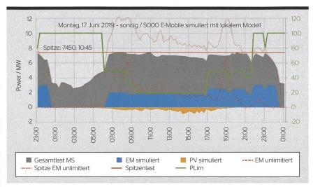
**Bild 4** Mit der Simulation wird deutlich, dass bei einer grossen Anzahl E-Mobilen die Ladeleistung zeitweise limitiert werden muss. Zu diesem Zweck wird ein PLim-Vorgabeprofil definiert.
