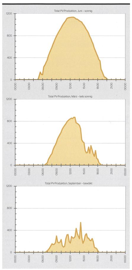
**Bild 1** Simulierte Lastprofile der PV-Anlagen in Fehraltorf bei unterschiedlichen Wetterverhältnissen. Bei Sonnenschein werden bis zu 1,1 MW eingespeist.
