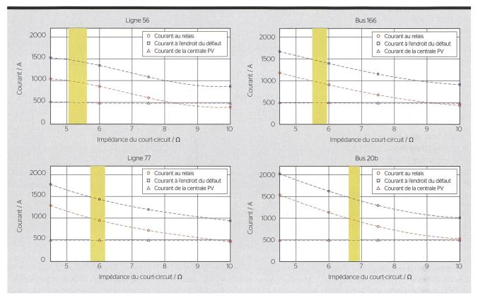
Figure 3 Résultats de l'analyse systématique de courts-circuits: situations de blinding aux points mis en évidence dans la figure 2.
