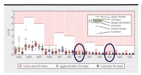
Bild 3 Box-Whisker-Plott, Mess- und Grenzwerte Spannungsharmonische. [1]
