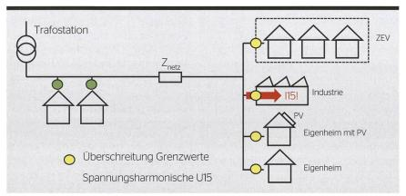
Bild 4 Problemsituation und Analysemöglichkeit der harmonischen Oberwellen.
