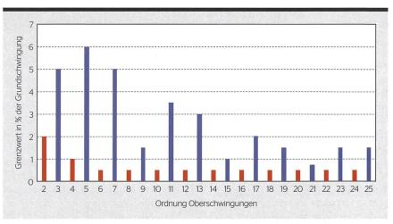
Bild 2 Grenzwerte der Spannungsharmonischen gemäss EN 50160:2019. [2]
