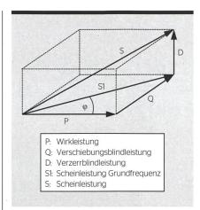
Bild 1 Zeigerdiagramm des Stromzählers.
