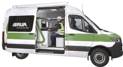
Der Kabelmesswagen Titron.
