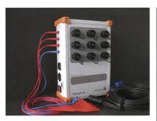
Messgerät für Lastganganalysen.
