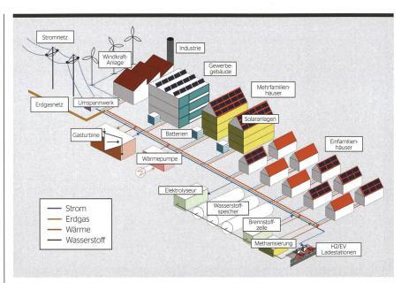
Bild 1 Technologien und Infrastrukturen für urbane, dezentrale Energiesysteme.
