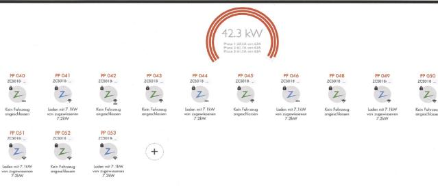
**Bild 2** Dynamischer Phasenausgleich in Aktion: Vollständig symmetrische Belastung bei Ladung von sechs zweiphasig ladenden Fahrzeugen.
